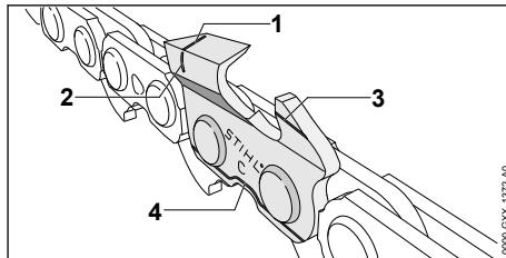
La chaîne STIHL est fabriquée avec des repères d'usure pour aider l'opérateur à identifier une usure excessive. Les repères d'usure décrits ci-dessus (1 - 4) doivent rester visibles.
