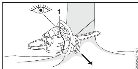
Lors de la réalisation de l'entaille, utilisez la visée de tir (1) de la tronçonneuse pour vérifier la direction de chute souhaitée :
