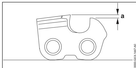
La jauge de profondeur détermine la profondeur à laquelle la gouge pénètre dans le bois et ainsi l'épaisseur des copeaux.
