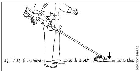
La tête faucheuse doit s'appuyer doucement sur le sol.
