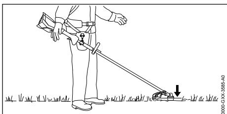
L'outil de coupe métallique doit planer à une hauteur d'environ 8 in. (20 cm) au-dessus du sol et doit reposer doucement sur le sol.
