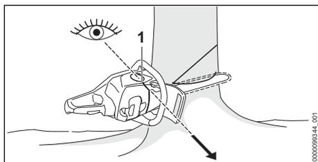
Lors de la réalisation de l'entaille, utilisez la visée de tir (1) de la tronçonneuse pour vérifier la direction de chute souhaitée :
