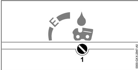
Le débit d'huile de chaîne convient à la plupart des applications lorsque la vis de réglage du débit d'huile (1) est en position **E** (Ematic).
