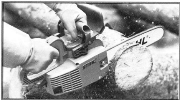
Tenue de la tronçonneuse pour coupe à longueur
